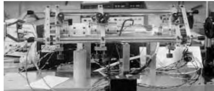
**Reproducción en el CENAM de la definición del metro mediante un Láser He-Ne estabilizado con una celda interna de yodo a una longitud de onda de  $632\,991\,398,22$  fm [10].**
