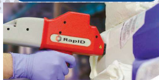
Equipo portátil para identificar materias primas sin abrir los contenedores
